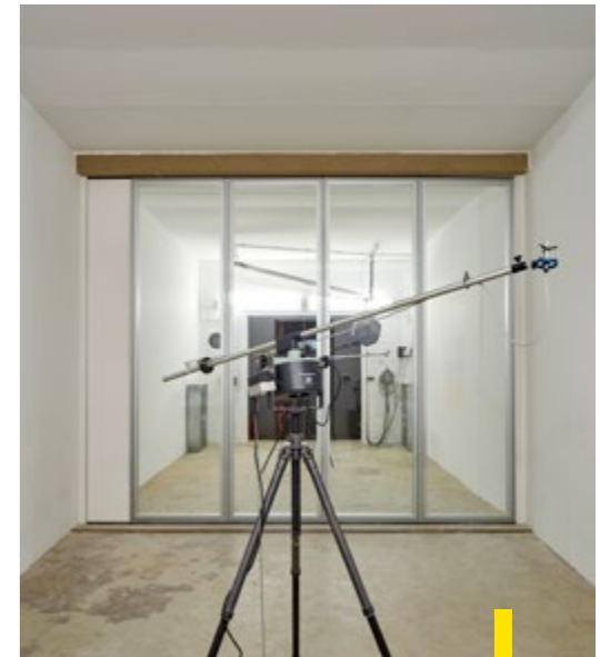
De wand wordt opgebouwd om te testen hoe geluidsisolerend de wand is.
