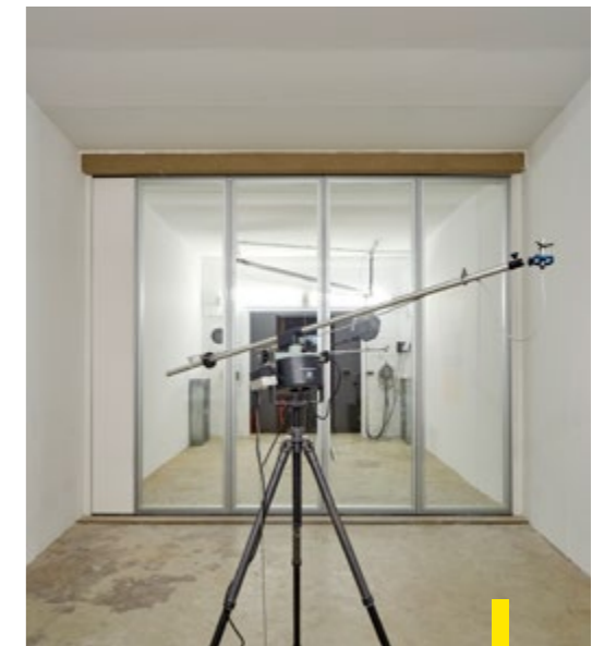
Die Wand wurde aufgebaut, um ihre Schalldämmung zu testen.
